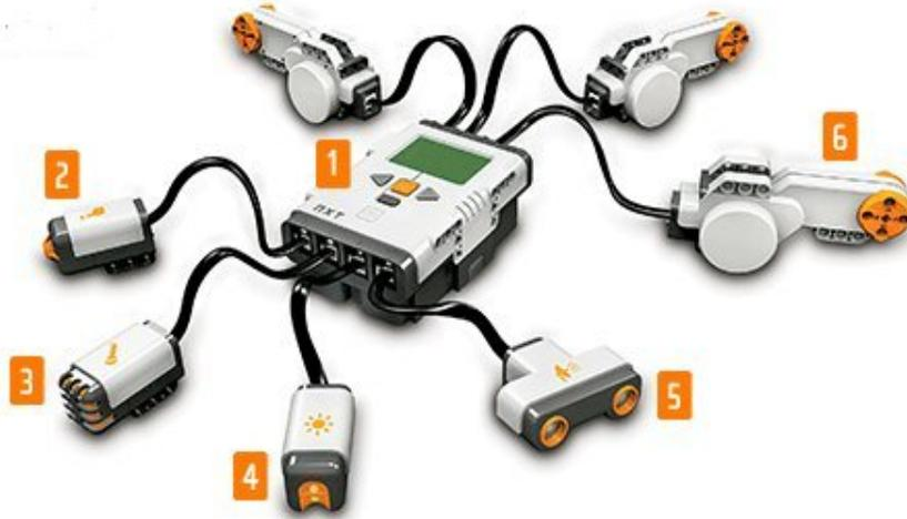
1. **NXT** : brick de contrôle intelligent, le cerveau du robot Mindstorms
