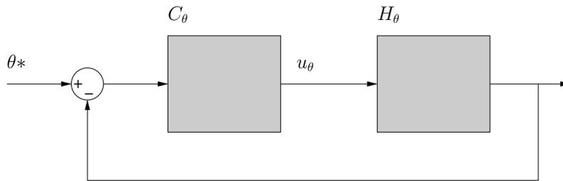
Figure 1. Schéma de commande de l'orientation  $u_\theta$
