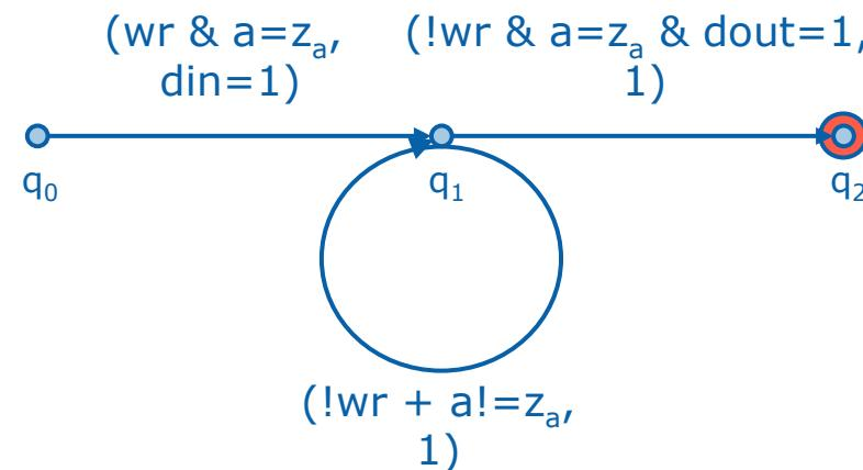
$(wr \& a=z_a, \text{din}=1) \quad (!wr + a!=z_a, 1)^* \quad (!wr \& a=z_a \& dout=1, 1)$
