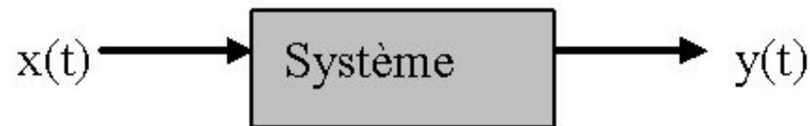
Exemple : Un modem qui transforme un signal  $x(t)$  binaire en un signal continu électrique, sur le réseau téléphonique.
