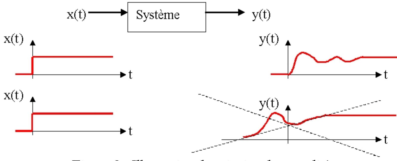
Si l'entrée  $x(t)$  est nulle pour  $t < 0$ , alors la sortie  $y(t)$  est aussi nulle pour  $t < 0$ .
