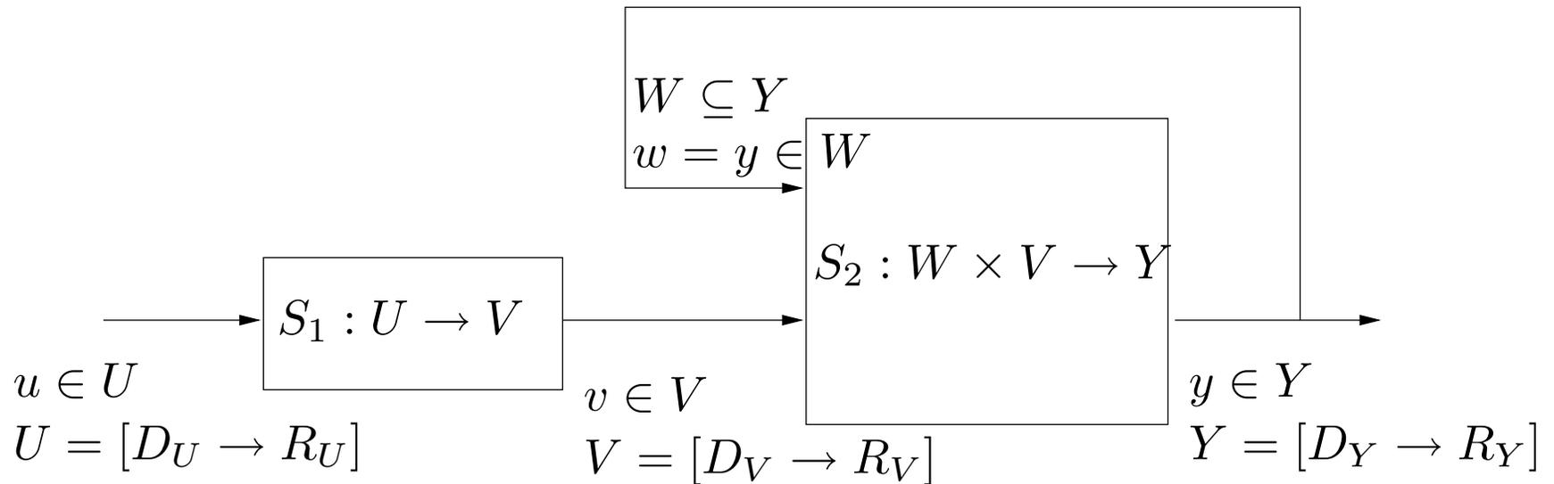
Le système global  $S_3 : U \rightarrow Y$  t.q.  $\forall u \in U : S_3(u) = S_2(S_3(u), S_1(u))$
