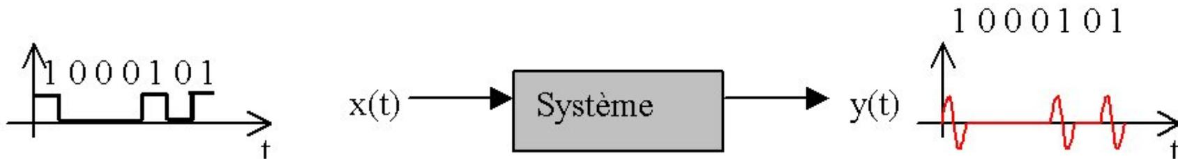
C'est un système en *boucle ouverte*, c-a-d la sortie se calcule directement à partir de l'entrée.
