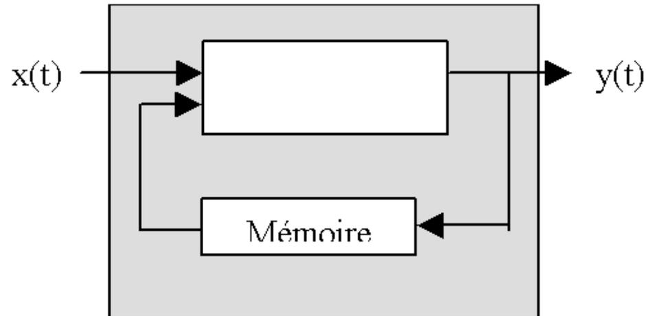
En temps continu, l'élément mémoire est formalisé par un intégrateur. La relation entrée/sortie est décrite par des équations différentielles faisant intervenir  $y(t)$  et ses dérivées.
