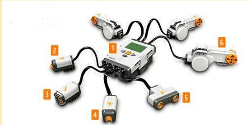
1. **NXT** : brick de contrôle intelligent, le cerveau du robot Mindstorms
